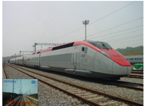
그림. 1 한국형 고속전철 시제차량(350km/h급) 본선 시험운전
