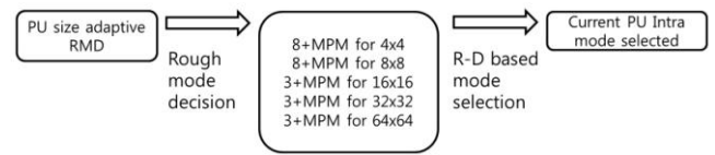
그림 1. RMD 후보 수 제한 및 MPM 추가 제안 방법 (Propose intra prediction)
