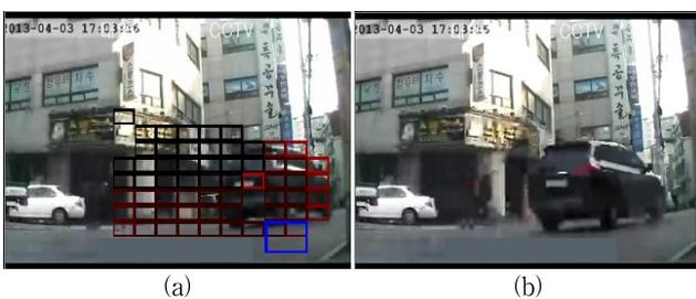
그림 4. 오감지 검출/방지 영상. (a) 오감지 영역 검출 (b) 오감지 방지 적용 결과
