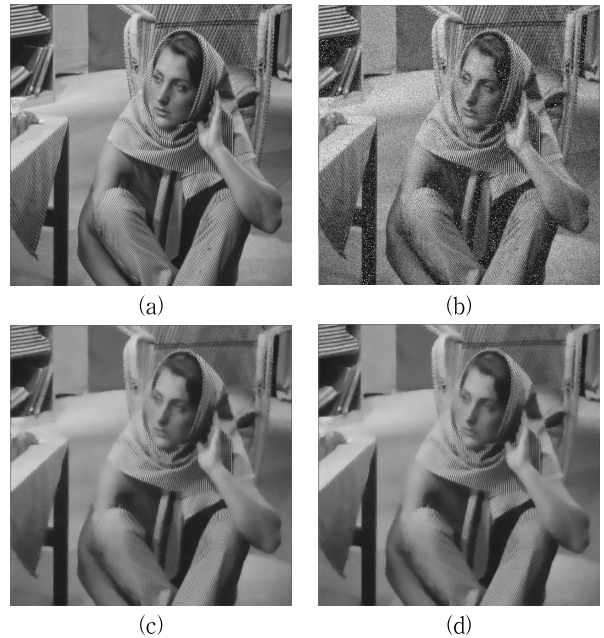
그림 6. (a) 원본 Barbara 이미지, (b) 표준편차가 20인 잡음이 낀 이미지, (c) 기존의 알고리즘, (d) 제안하는 알고리즘
