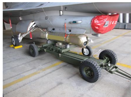
Fig.12 트롤리 장착성능 시험
