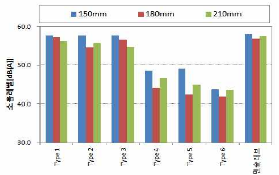
Fig.4 시료별 슬래브 조건에 따른 소음레벨 측정결과(매트볼 낙하높이:100cm)
