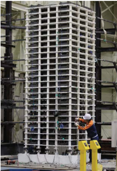
Figure 1 25층 공동주택 내진실험
