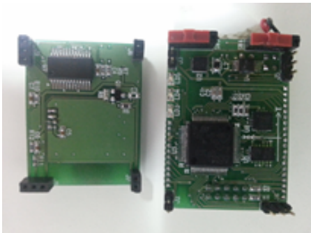
그림 1. 자이로 센서와 가속도 센서 전송 모듈 Fig. 1. Acceleration and Gyro Sensor transport module
