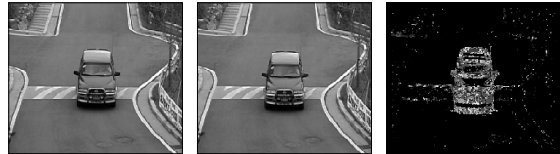
그림 4. 제한한 이동물체 분할. Fig. 4. proposed Moving Object Segmentation.
