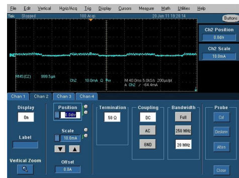
그림 9 저항을 이용한 누설전류 1mA 전류파형
