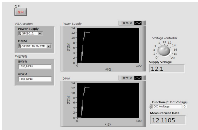
그림 4 GUI 제어 및 모니터링 실험 결과
