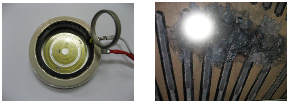
그림 1. 전력용반도체소자의 열폭주에 의한 소손
