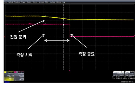
그림 4 커패시터가 방전되는 동안 DC Link 전압 및 부하전류 Fig. 4 DC Link voltage and load current during capacitor discharge
