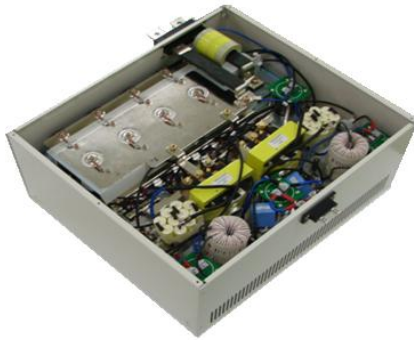
그림 4 개발된 12V, 1000A 양방향 DC-DC 컨버터
