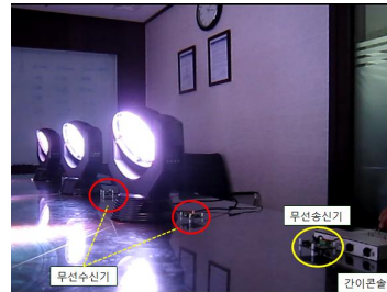
그림 5 DMX512 무선 네트워크 Fig. 5 DMX512 Wireless Network
