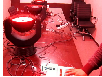
그림 4 DMX512 유선 네트워크 Fig. 4 DMX512 Wire Network
