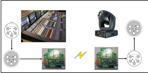
그림 2 무선 DMX512 시스템 구성 Fig. 2 System Configuration for wireless DMX512
