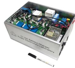
그림 6 제한한 3kW급 배터리 충전기 시작품
