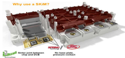
그림 3 SKiP, Spring & Sinter 기술이 적용된 SKIM
