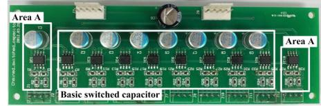
그림 4. 제작된 전하균일 회로의 사진
