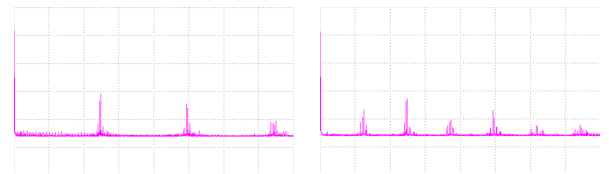
(a) 기존 제어기법 (b) 제안 제어기법 그림 6. 출력 선간전압 FFT분석(x축:1kHz/div, y축:1v/div)
