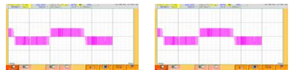
(a) 기존 제어기법 (b) 제안 제어기법 그림 5. 출력 선간전압 FFT분석(x축:50ms/div, y축:5V/div)
