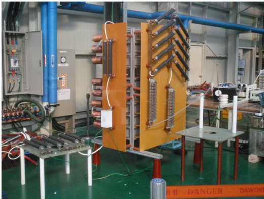
그림 5. 인버터형 고정밀 고전압 전원장치 시험 설비
