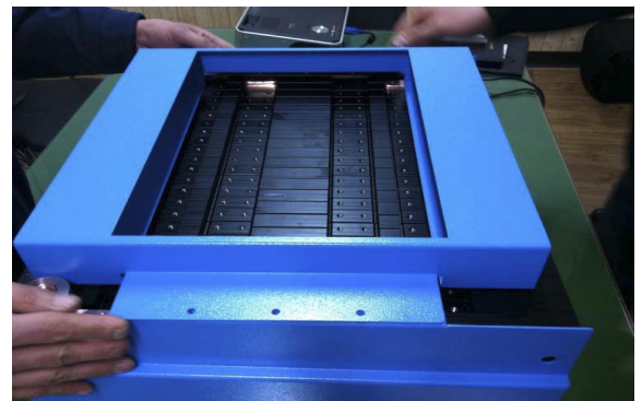
그림 2 리튬이온 배터리팩 실물과 상부 케이스 Fig. 2 Li-ion Battery Pack & Upper Case
