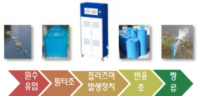
그림 8 플라투스 시스템 구성 및 흐름도 Fig. 8 PLATUS system configuration and flow
