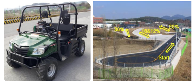
(a) 제작된 전기 농용 다목적 차량 및 주행시험장
