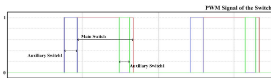
그림 4 주스위치와 보조스위치의 PWM 신호 Fig. 4 PWM signals of the main and auxiliary switches
