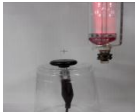
그림 1 헬륨-네온 램프를 이용한 전계 세기 측정 Fig. 1 Measurement of electric field intensity using a He-Ne lamp
