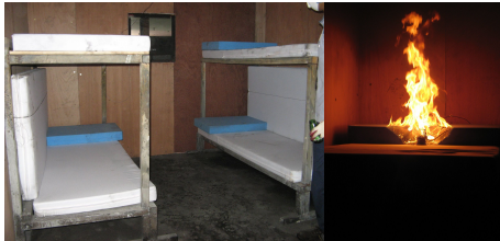
Figure 5. 선실 상부 침대 가연물 배치 및 화원 점화
