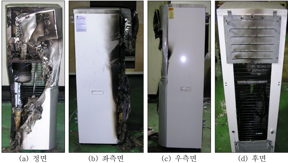
그림 2. 화재가 진압된 후의 연소 패턴 해석을 위한 실체사진
