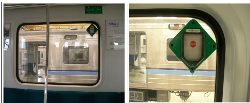
그림 1. 인천메트로 1호선 신조전동차 비상탈출장치
