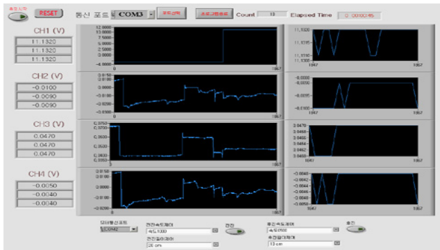
그림 6 . LabVIEW를 통한 4-channel Hall effect gaussmeter의 구현.
