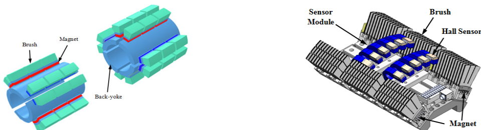
그림 2. PIG 자계 인가시스템 설계 및 제작
