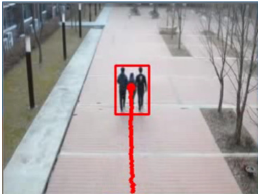
그림 3. 객체별 좌표 리스트를 이용한 이동궤적 추출 영상
