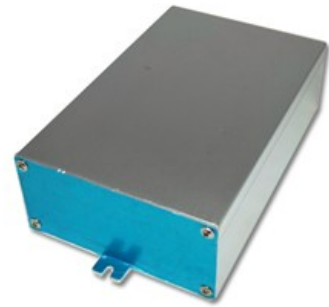
그림 3. FPGA 기반의 스테레오 정합 장치 (100x160x68mm)
