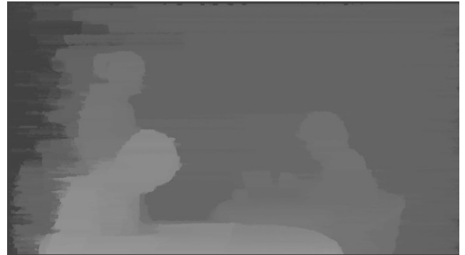
그림 6. 그림 4(c)변이 영상의 적응적 교차-3자 변이 필터링 적용 결과
