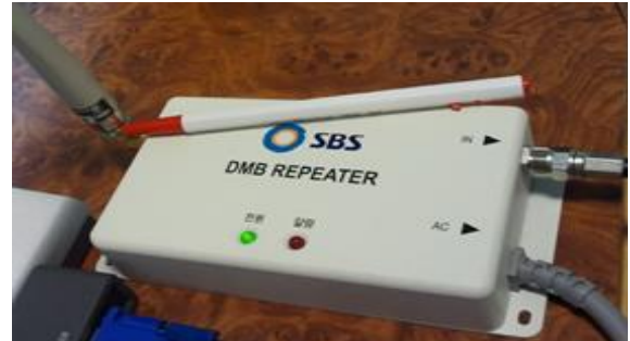
그림 9. 가정용 DMB SFN Gap Filler
