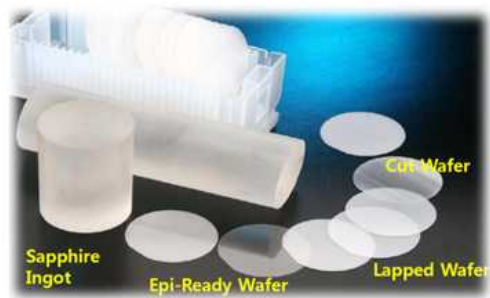
Fig. 2 Sapphire Ingot & Wafer
