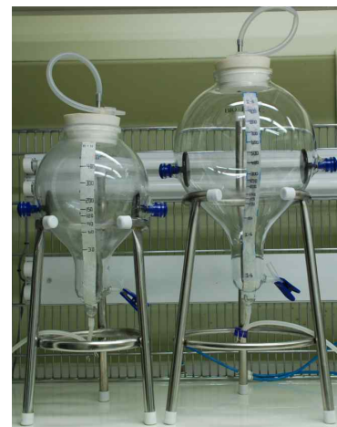
[그림 1] 고주파 파형 처리용 5L (좌) 및 10L (우) 생물반응기
