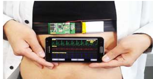
그림 3. 무선통신부(Bluetooth)를 이용한 스마트폰 모니터링.
