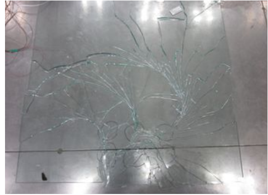
그림 5. 비강화 평면 단판유리(면취有) 열파손 형상
