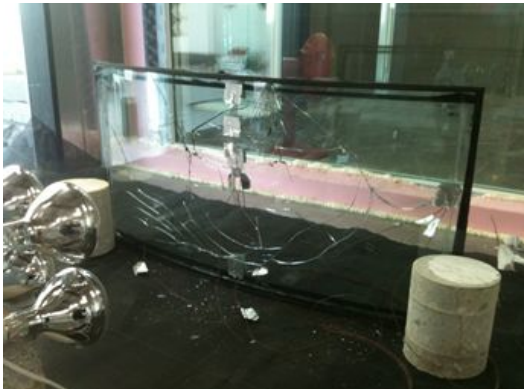
그림 12. 비강화 곡면 복층유리 열파손 형상(수직)
