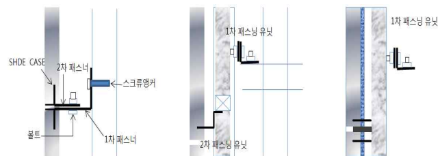
그림 5. 중량 건축마감재 부착 공법의 종류
