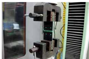
사진 2. 합성고분자계 시트 시험 현황
