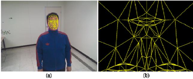
(그림 4) 구현 중인 실시간 나이 인식 시스템의 (a) 얼굴 인식 및 영역 검출 예제, (b) 얼굴 인식에 사용되는 특징점 마스크(Mask)
