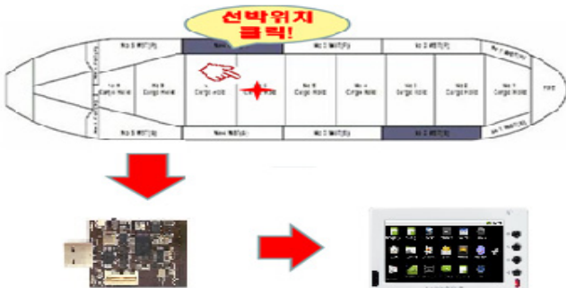
그림 2. 선박 내 통합센서 모니터링 시스템 구성도
