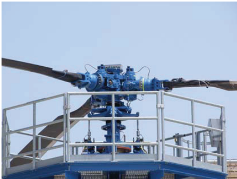
그림 4 동적밸런싱용 로터 헬타워 장비
