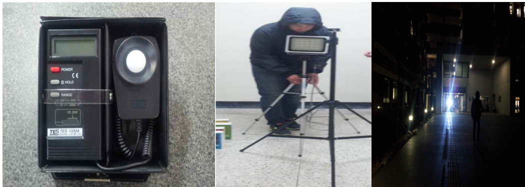
그림.2 조도측정기(TES-1330A) 그림.3 실내 조도 측정 그림.4 실외 조도 측정
