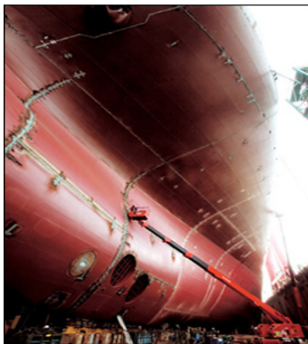
그림 1 기존의 선체 청소방법
