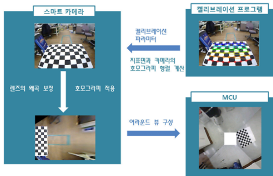
그림 7. 어라운드 뷰의 영상 처리 과정 Fig. 7. Image processing of around view
