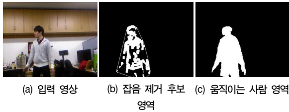
그림 5. 개선된 깊이 세분화를 이용한 움직이는 사람 영역 검출 결과
