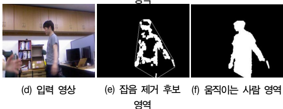
(a) 입력 영상 (b) 잡음 제거 후보 영역 (c) 움직이는 사람 영역
