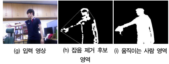
그림 6. 개선된 깊이 세분화를 이용한 움직이는 사람 영역 검출의 실험 결과
