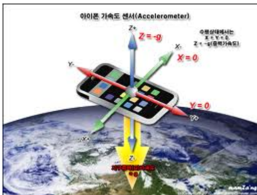
그림. 2 iPhone 가속도 센서의 데이터 형태 Fig. 2. Data type of the iPhone Accelerometer Sensor
