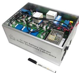
그림 3 개발된 3.3kW급 차량탑재형 충전기
