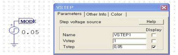
그림 2 PSIM의 Vstep 함수 Fig. 2 Vstep function of PSIM
