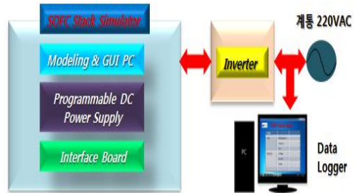
그림 1 SOFC Stack 시뮬레이터 도식 Figure 1 Diagram of SOFC Stack Simulator
